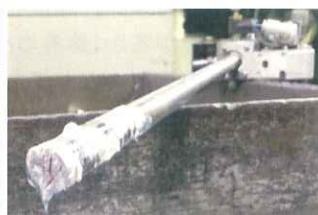
図8 アルミ溶湯浸漬テスト
