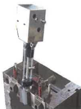
図5. CDV金型取付
