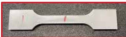
JIS : Z2241 14B号引張試験片 (6面切断)
