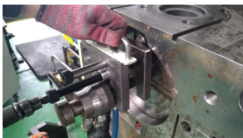
図4-1 加圧ピン引き抜き工具
