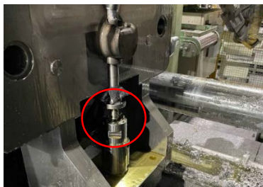
図 3-6 連結ボルトの破断
